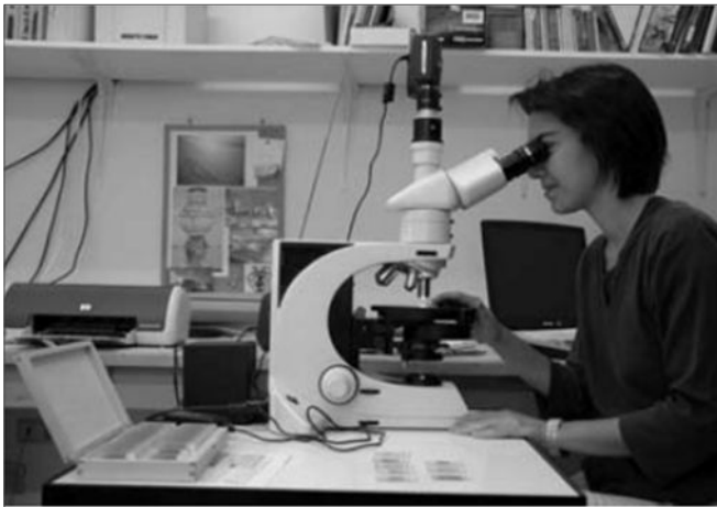
تصویر ۲: کاربر در حال استفاده از میکروسکوپ پلاریزان برای مطالعه مقطعی نازک از سفال، موسسه‌ای ما قبل تاریخ اژه در کرت شرقی، یونان.
