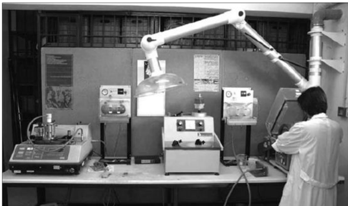
تصویر ۳: استفاده از اره الماسه در آزمایشگاه پتروگرافی ویلیام مک دونالد ۱ در موسسه‌ی پیش از تاریخ اژه برای کرت شرقی، یونان.
