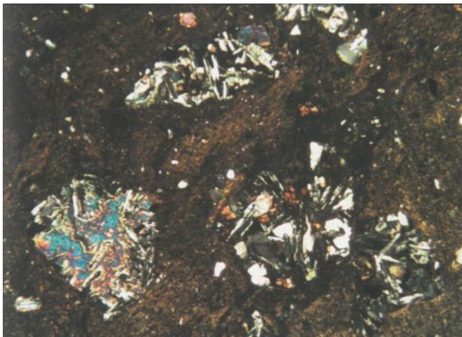
شکل ۳: قطعات گرد سنگ‌های آذرین آتش‌فشانی، متشکل از پلاژیوکلازهایی که به صورت تصادفی جهت‌دار شده‌اند، بلورهای رنگی بزرگ کلینوپروکسن ۱ و الیوین ۲ هوازده که مشتق شده از بازالت هستند. سفال عصر مفرغ، انگلستان. XPL عرض تصویر: ۳/۸ mm. (Quinn, 2013)
